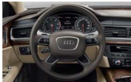
**Volante de cuero multifunción con diseño de 4 radios con levas de cambio**
