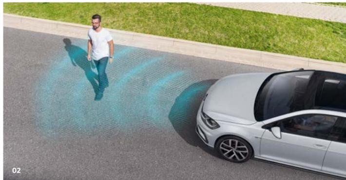
**02** Cuida de ti y de los demás: El **sistema de observación del entorno "Front Assist"** incluye la **función de asistente de frenada en ciudad con reconocimiento de peatones** que en caso de colisión inminente puede ayudar a reducir la gravedad del accidente o, incluso, a evitarlo. Reconoce a los peatones y otros obstáculos en el camino y advierte al conductor.<sup>1)</sup> Si no hay respuesta, el vehículo inicia una maniobra de frenado de emergencia. **S**
