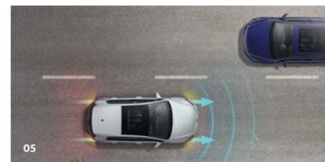
**04** El sistema de **control automático de distancia "ACC"** adapta automáticamente la velocidad<sup>2)</sup> a la velocidad del vehículo que circula delante y se detiene a la distancia indicada por el conductor<sup>1)</sup>. Junto con la transmisión de doble embrague DSG, este sistema forma parte del asistente de emergencia y del asistente para atascos. **S**
