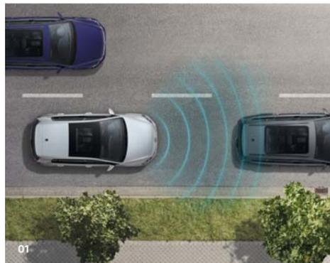
**01** Mayor confort, incluso en los atascos. El **asistente para atascos "Traffic Jam Assist"** permite una conducción cómoda durante los atascos y ayuda a evitar las situaciones típicas que pueden producirse en uno.<sup>1)</sup> El sistema mantiene el vehículo en el carril y lo dirige combinando la transmisión de doble embrague DSG automático, la aceleración y los frenos. **S**
