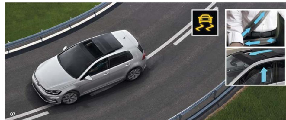
**07** El **sistema de protección de los ocupantes** proactivo detecta mediante los sensores de ESC y el sistema de observación del entorno "Front Assist" situaciones críticas con gran potencial de accidente. Cuando el sistema detecta este tipo de situaciones, los pasajeros y el vehículo se preparan para el accidente: Los cinturones delanteros se tensan y conductor y acompañante quedan bien sujetos. Se cierran las ventanas y el techo solar dejando solo una pequeña apertura. **S**
